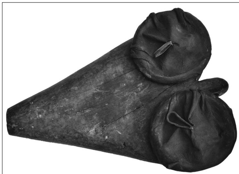
Figura 11. Sistema bífido de fuelles empleado en los trabajos de forja tradicional en Mali.
