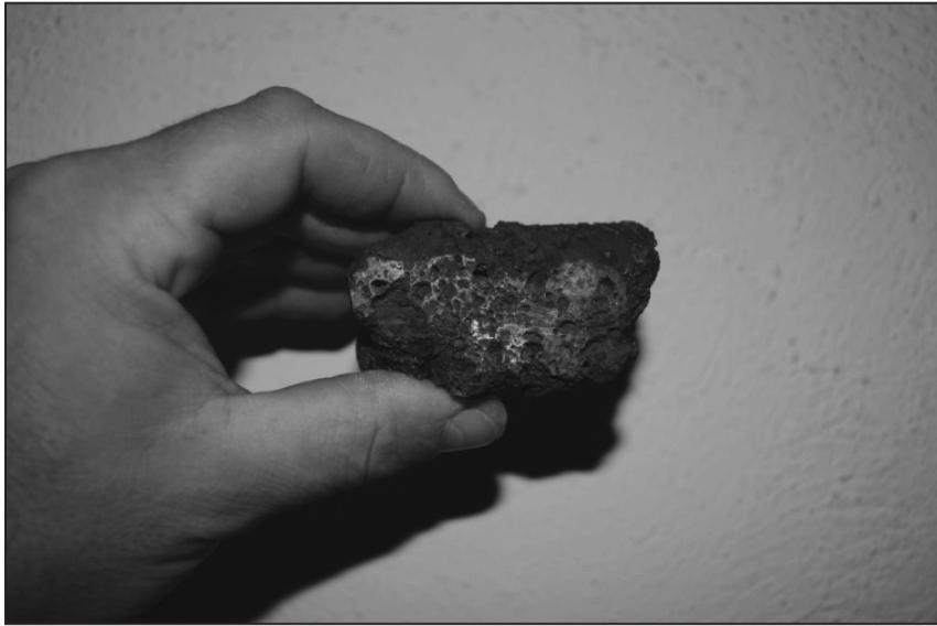
Figura 4. Uno de los fragmentos seccionados de una esponja de hierro del horno “ELTERKER” (Foto: ARTIFEX, crpa)
